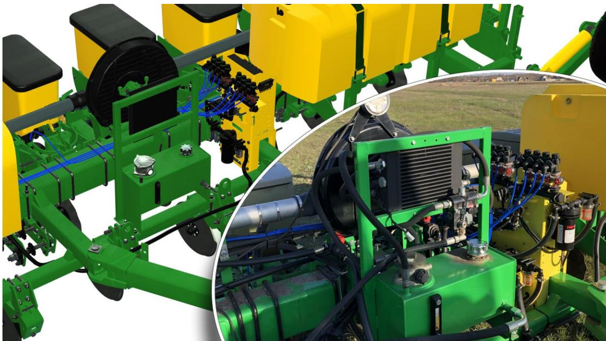
Рис. 1 Пример расположения системы дозирования на пропашном посевном комплексе
