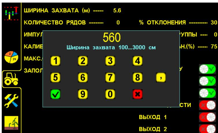
«Окно настроек» для ввода ширины захвата агрегата. Рис.59
