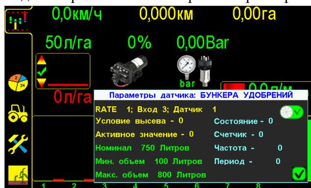
«Графический экран внесения» с «окном настроек» параметров «функции контроля наполнения бака по расходомеру». Рис.38
