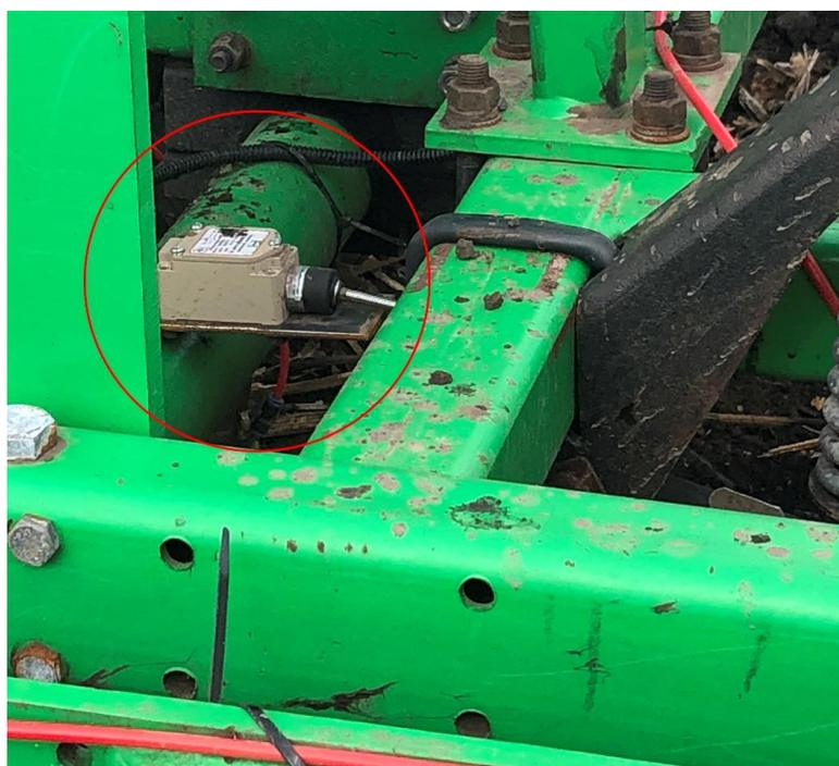
**Рис. 21** Пример установки датчика положения раме культиватора
