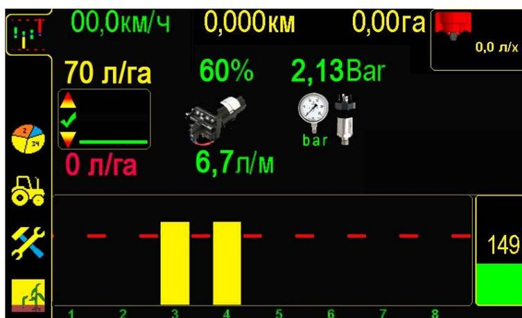
Графический экран. Проверка равномерности вылива перед калибровкой в режиме «Р». Рис.68
