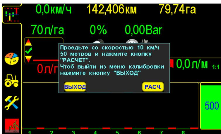
«Окно калибровки» «датчика пути» по скорости агрегата. Рис.64
