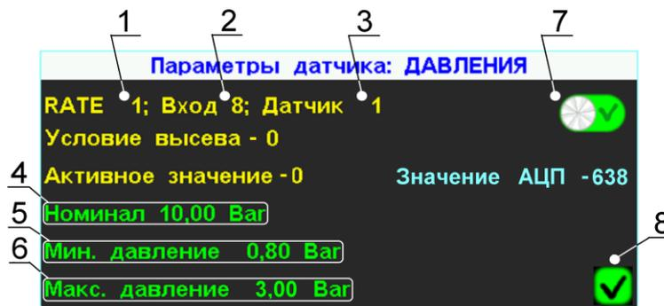
Фрагмент «графического экрана внесения» с «окном настроек» параметров «датчика давления». Рис.37
