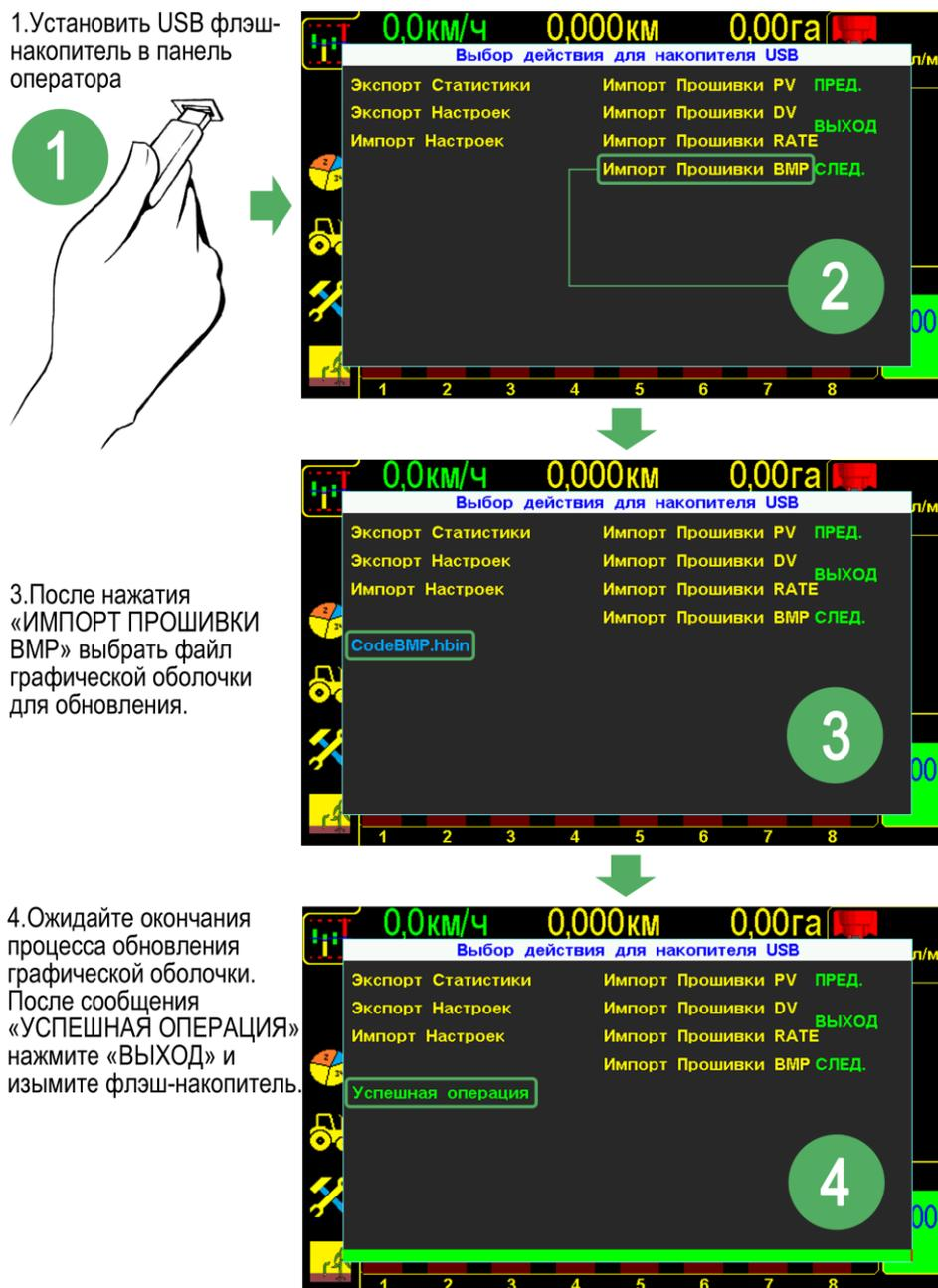
Рис.86 Последовательность действий для обновления графической оболочки панели оператора
