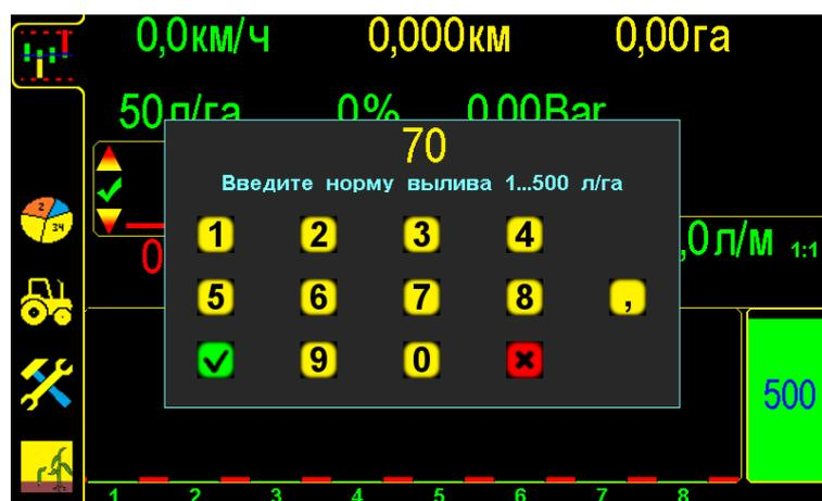
«Графический экран внесения» с «окном настроек» значения «нормы внесения»
