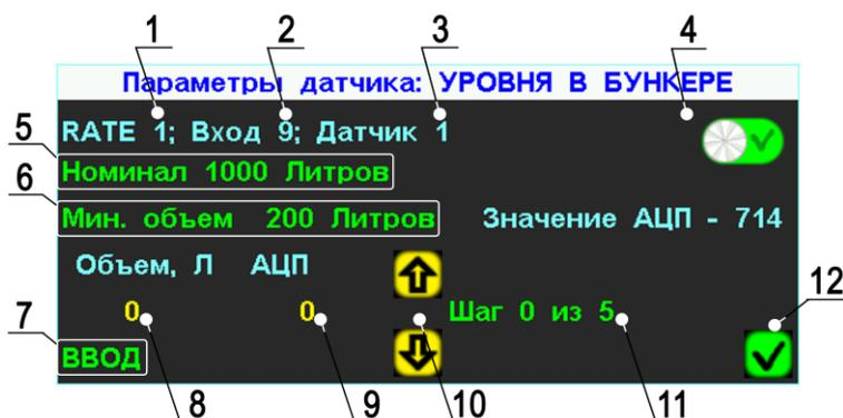
Фрагмент «графического экрана внесения» с «окном настроек» параметров «функции контроля наполнения бака по расходомеру». Рис.41
