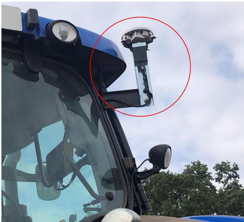
**Рис. 19** Пример установки GPS датчика скорости на тракторе
