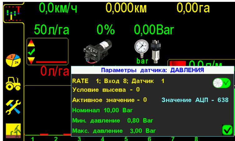
«Графический экран внесения» с «окном настроек» параметров «датчика давления». Рис.36
