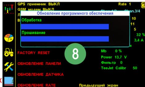
Рис.85 Последовательность действий для обновления ПО Rate контроллера
