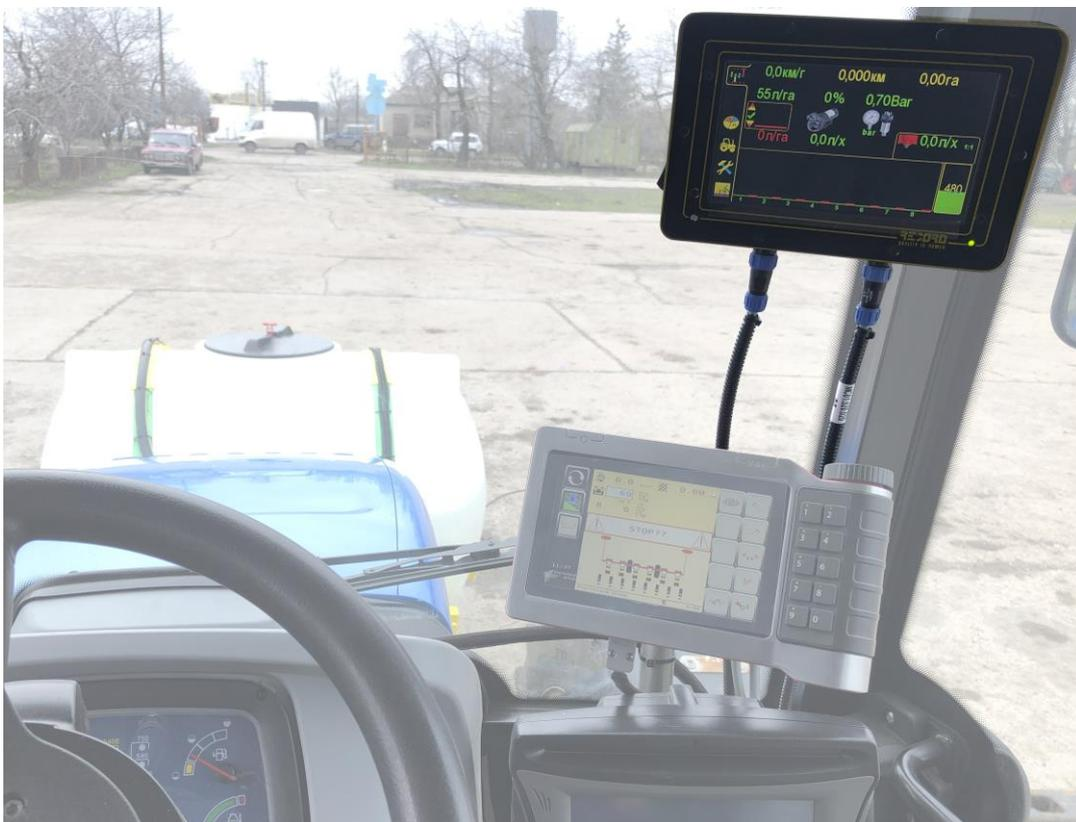
**Рис. 2 Расположение панели оператора «Record» в кабине трактора**
