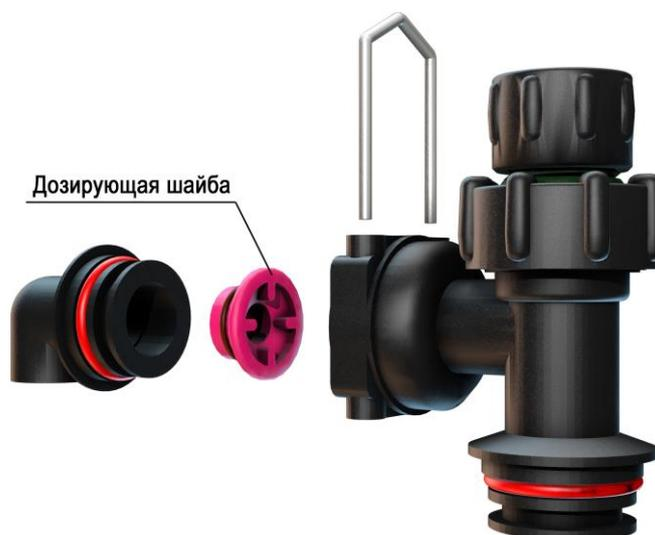
**Рис.16 Установка дозирующей шайбы в фитинг обратного клапана**
