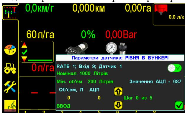
«Графический экран внесения» с «окном настроек» параметров «функции контроля наполнения бака по расходомеру». Рис.40
