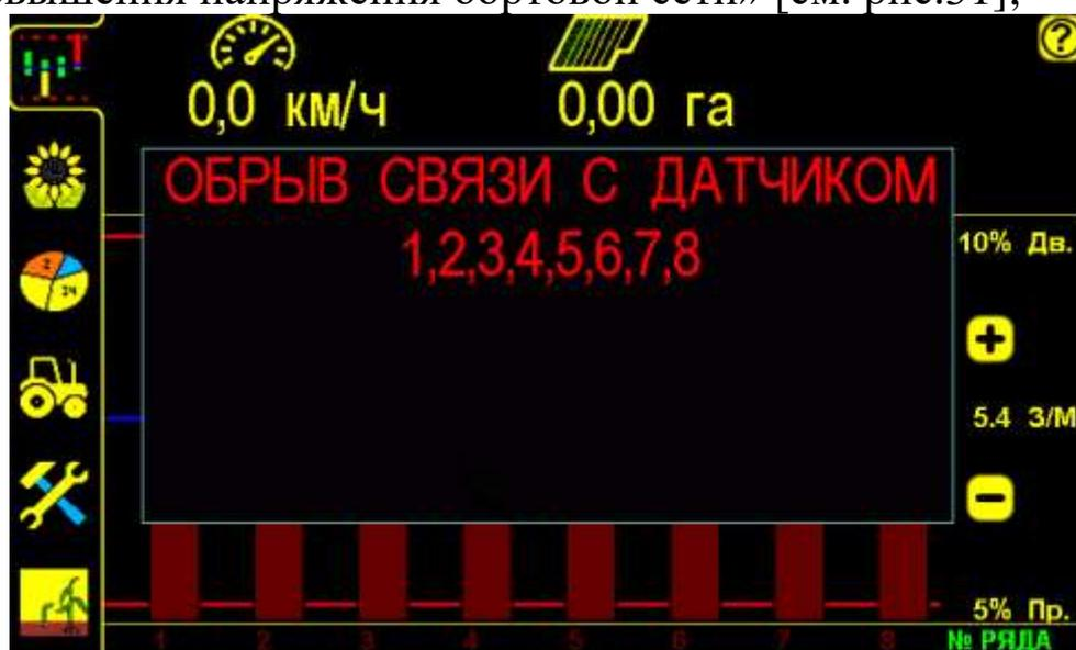
«Обрыв связи с датчиком высева» рис.29
