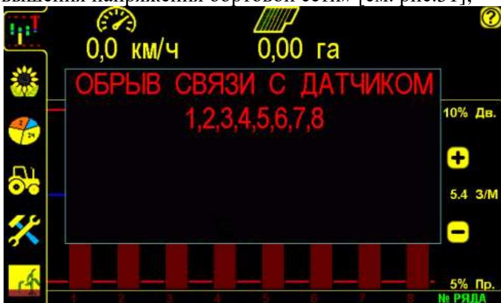
«Обрыв связи с датчиком высева» рис.29
