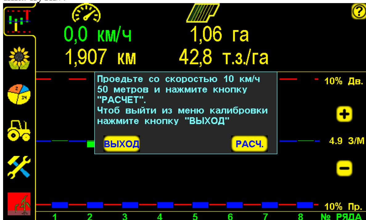
«Окно калибровки» датчика пути по скорости агрегата рис.20
