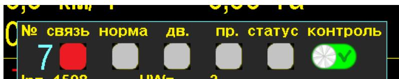
**Фрагмент «окна состояния датчика» в случае «обрыва связи с датчиком» рис.37**
