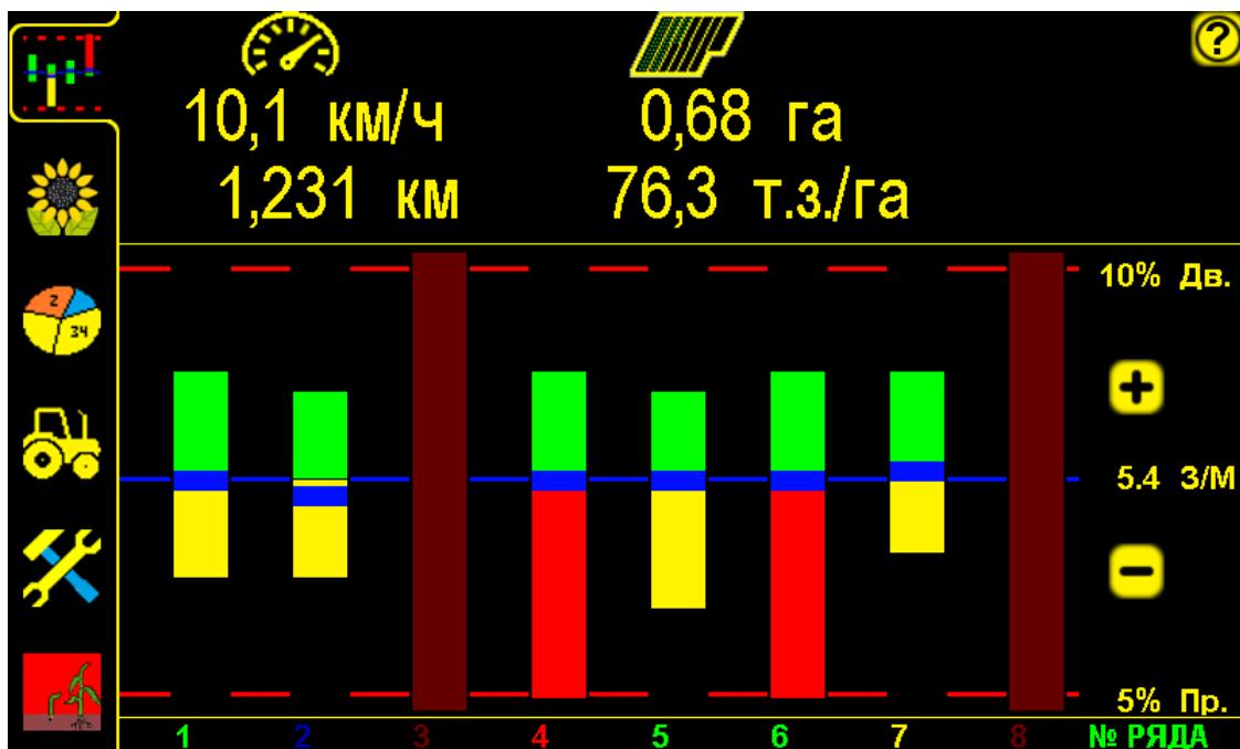
**Отсутствие датчиков №3 и №8 в сети системы рис.44**
