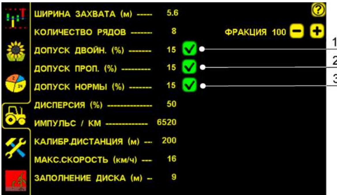
«Экран рабочих настроек» для установки значений допусков рис.25
