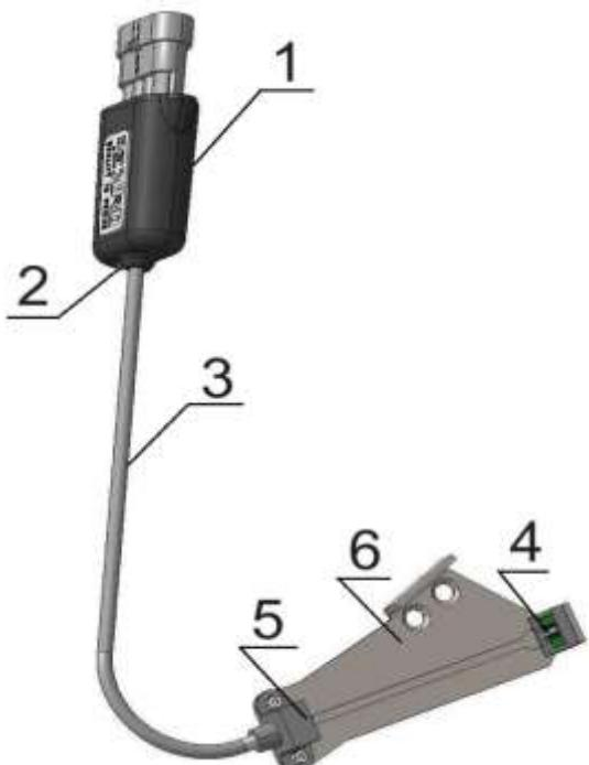
1. Корпус датчика с платой.
