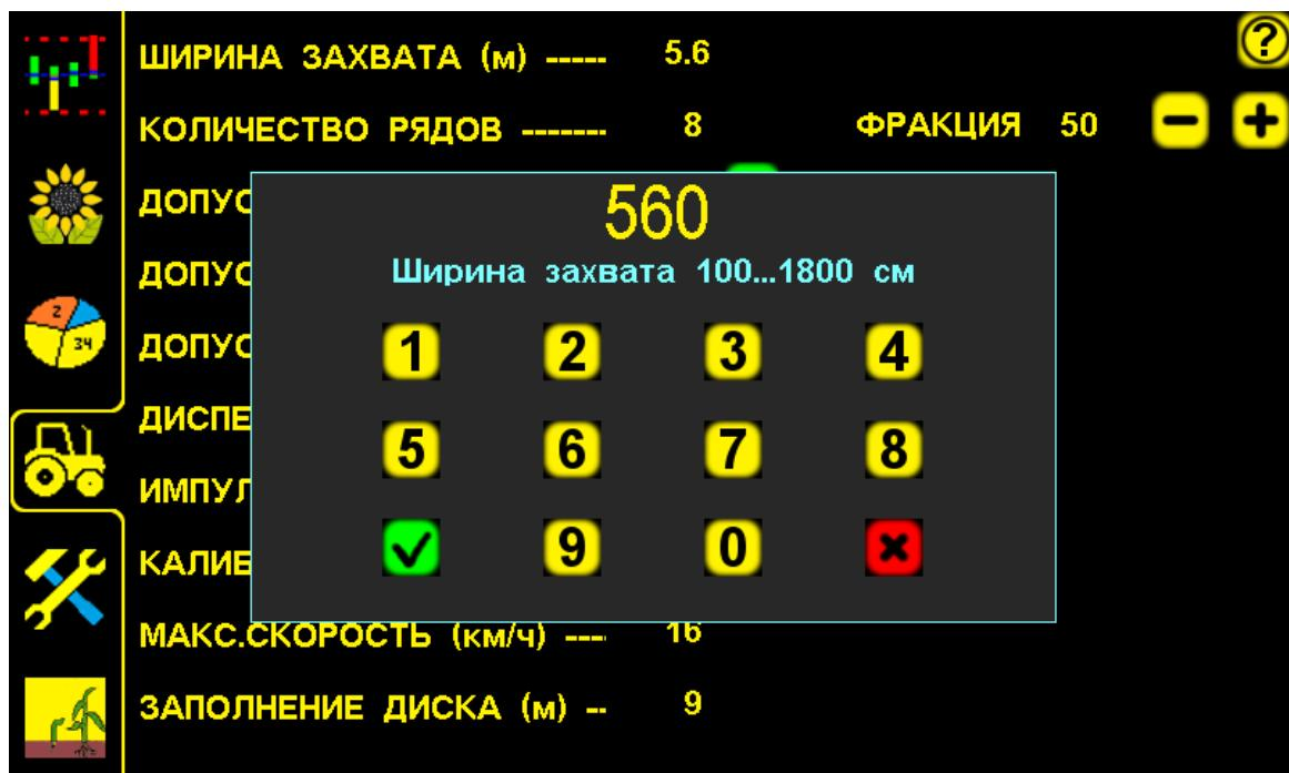
«Окно настроек» для ввода ширины захвата сеялки рис.15
