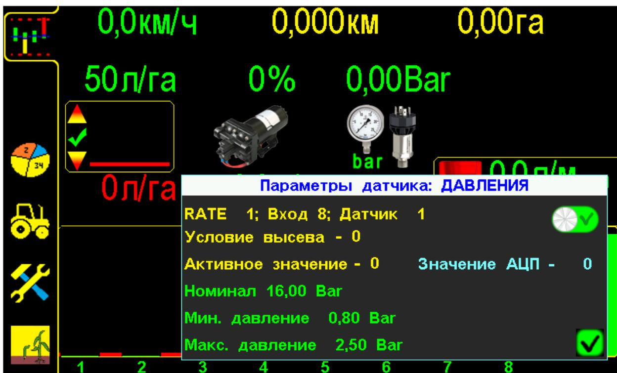
«Графический экран внесения» с «окном настроек» параметров «датчика давления» рис.10
