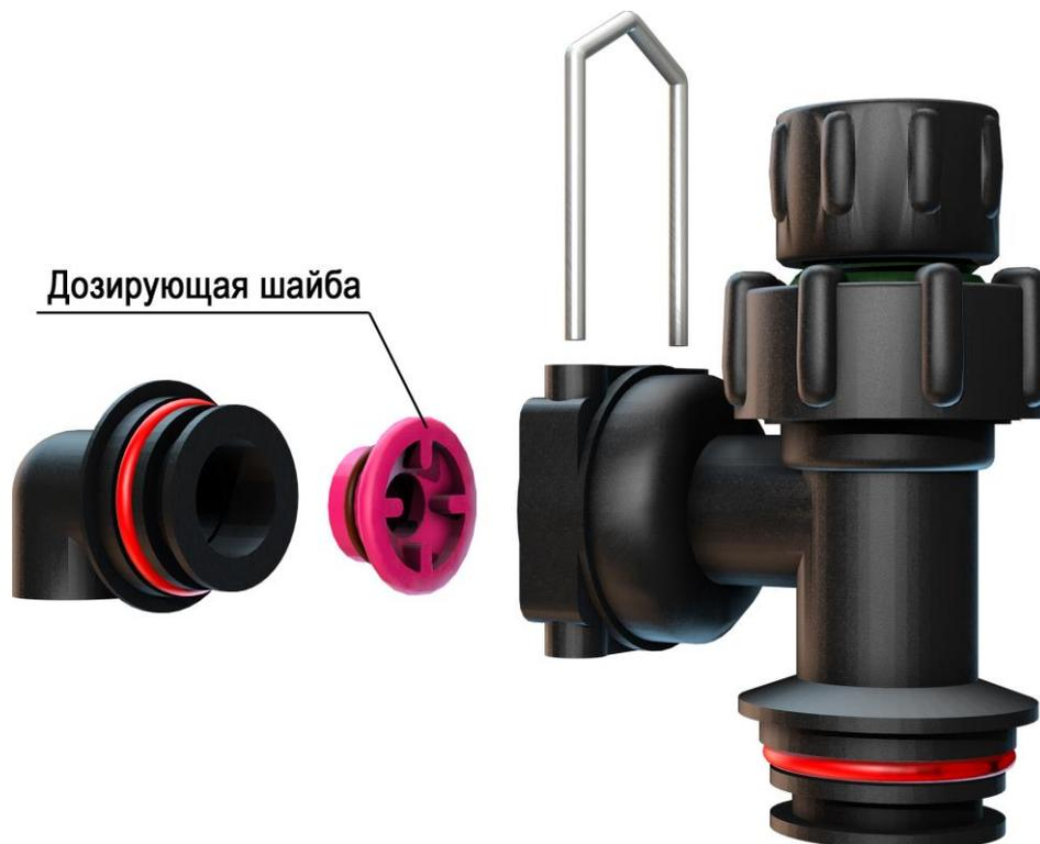
**Установка дозирующей шайбы в фитинг обратного клапана рис.4**
