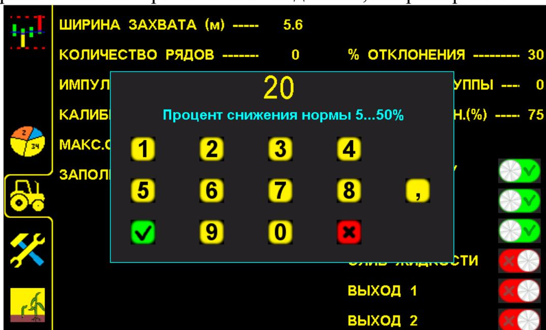
Установка значения допустимого отклонения уровня «нормы внесения» рис.26
