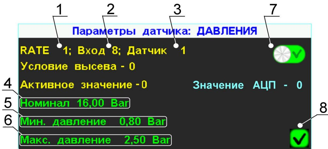
Фрагмент «графического экрана внесения» с «окном настроек» параметров «датчика давления» рис.11
