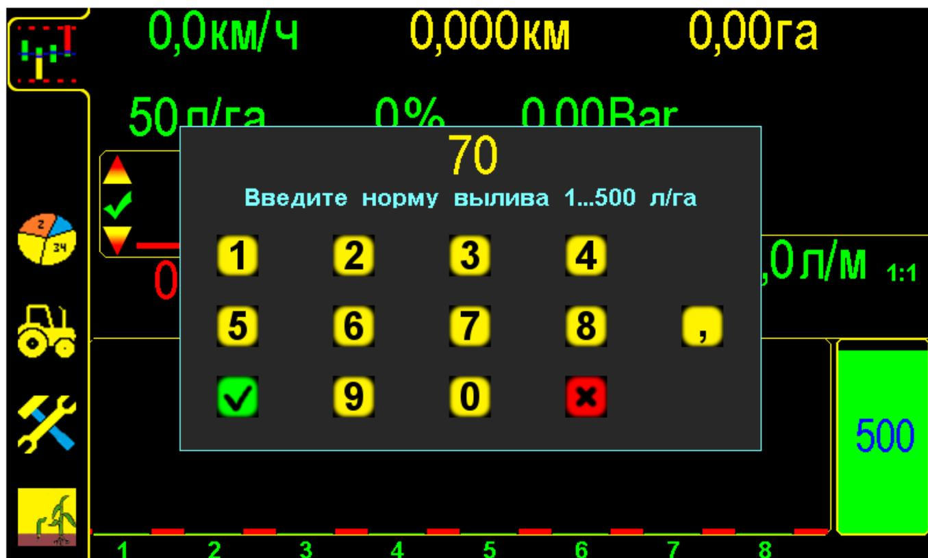
«Графический экран внесения» с «окном настроек» значения «нормы внесения» рис.9
