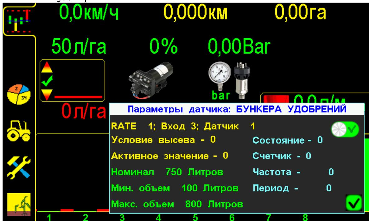
«Графический экран внесения» с «окном настроек» параметров «функции контроля остатка удобрений» рис.12
