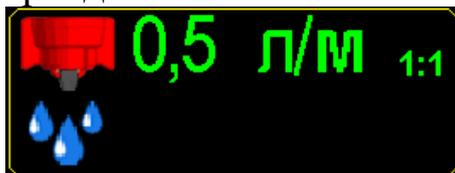
[см.стр.21 рис.8 п.9] (все поле символа активно), для установки **аварийного уровня «нормы внесения»**, система автоматически рассчитает аварийный уровень (обозначается красной линией на экране и отображается значением л/м).
