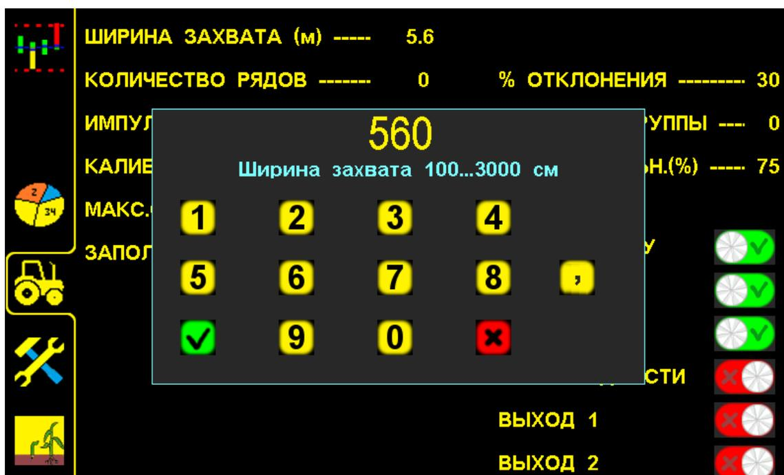
**«Окно настроек» для ввода ширины захвата сеялки рис.20**
