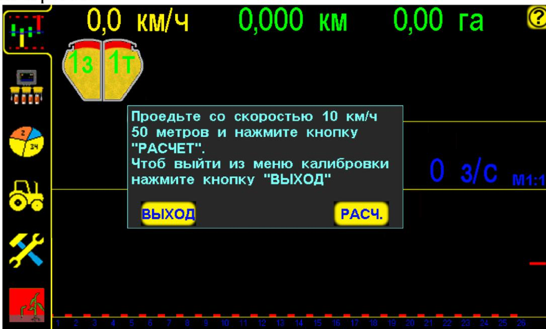
«Окно калибровки» «датчика пути» по скорости агрегата рис.15
