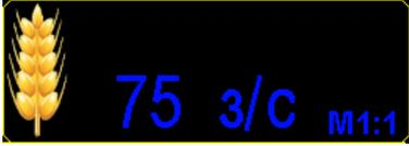
[см. стр.9 рис.4 п.6] (все поле символа активно), для установки аварийного уровня «потока высева», система автоматически рассчитает аварийный уровень (обозначается красной линией на экране и отображается значением з/с).
