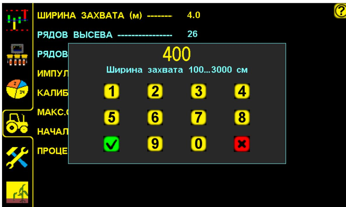
Установка рабочей ширины захвата сеялки рис.10
