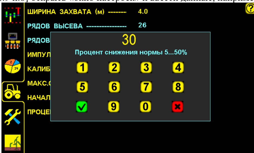
Установка значения допустимого отклонения уровня «потока высева» рис.18
