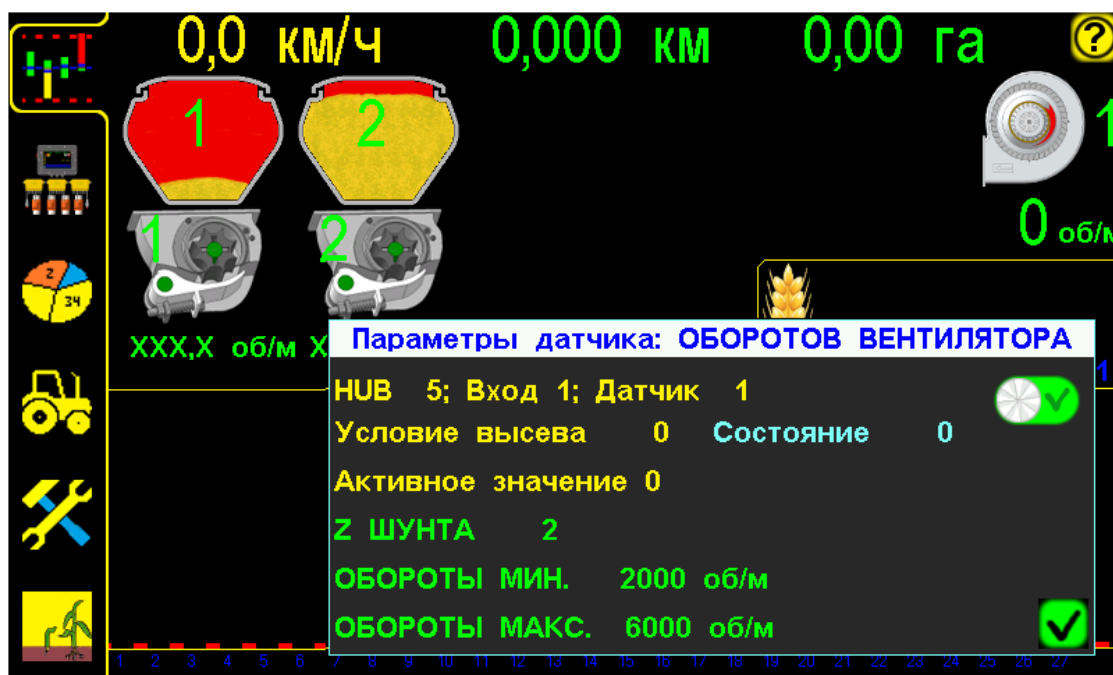
«Графический экран высева» с «окном настроек» параметров «датчика оборотов вентилятора» рис.5
