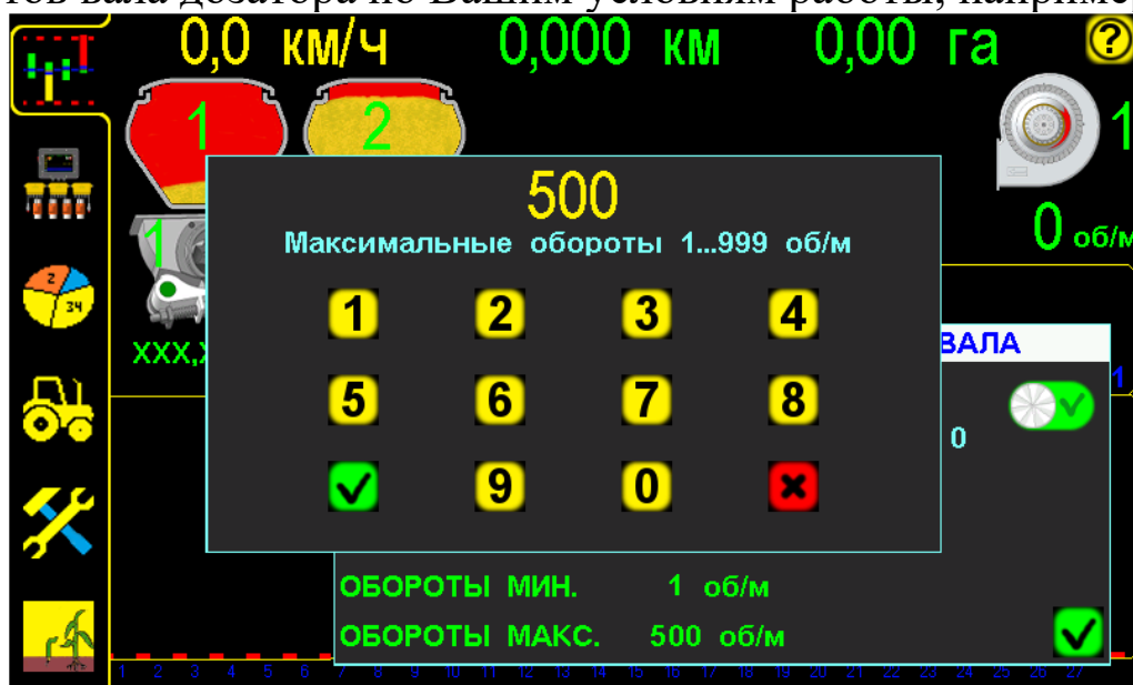
Установка максимального значения оборотов вала дозатора рис.14
