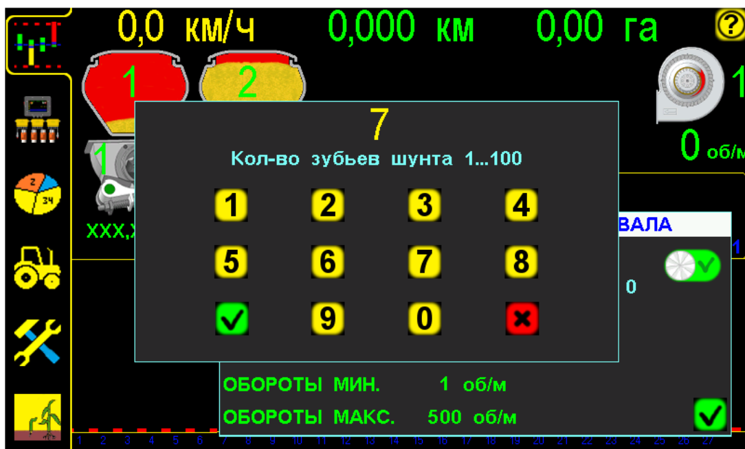
Установка количества зубьев шунта «датчика оборотов вала дозатора» рис.12
