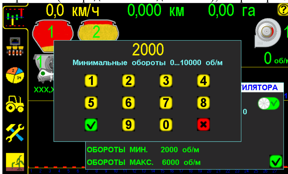
Установка минимального значения оборотов вентилятора рис.8
