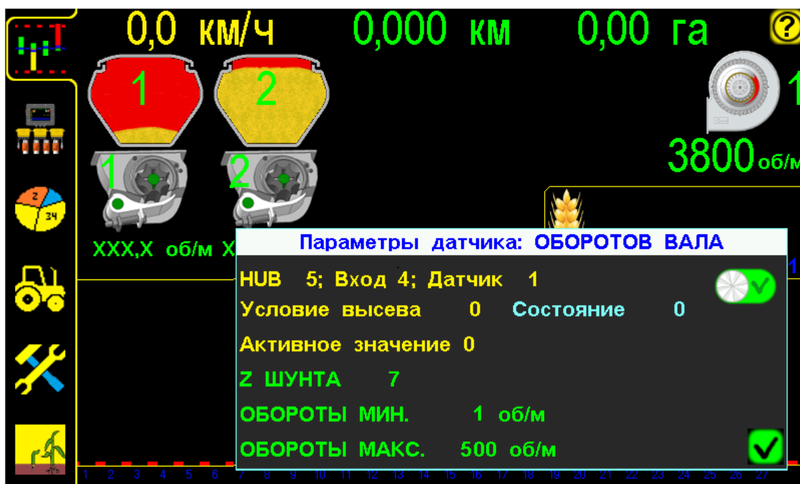
«Графический экран высева» с «окном настроек» параметров «датчика оборотов вала дозатора» рис.10
