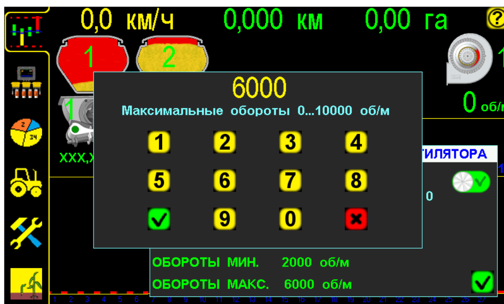
Установка максимального значения оборотов вентилятора рис.9
