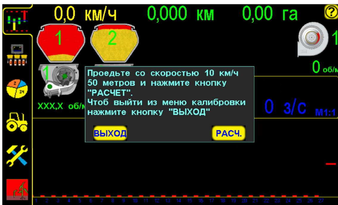
«Окно калибровки» «датчика пути» по скорости агрегата рис.25
