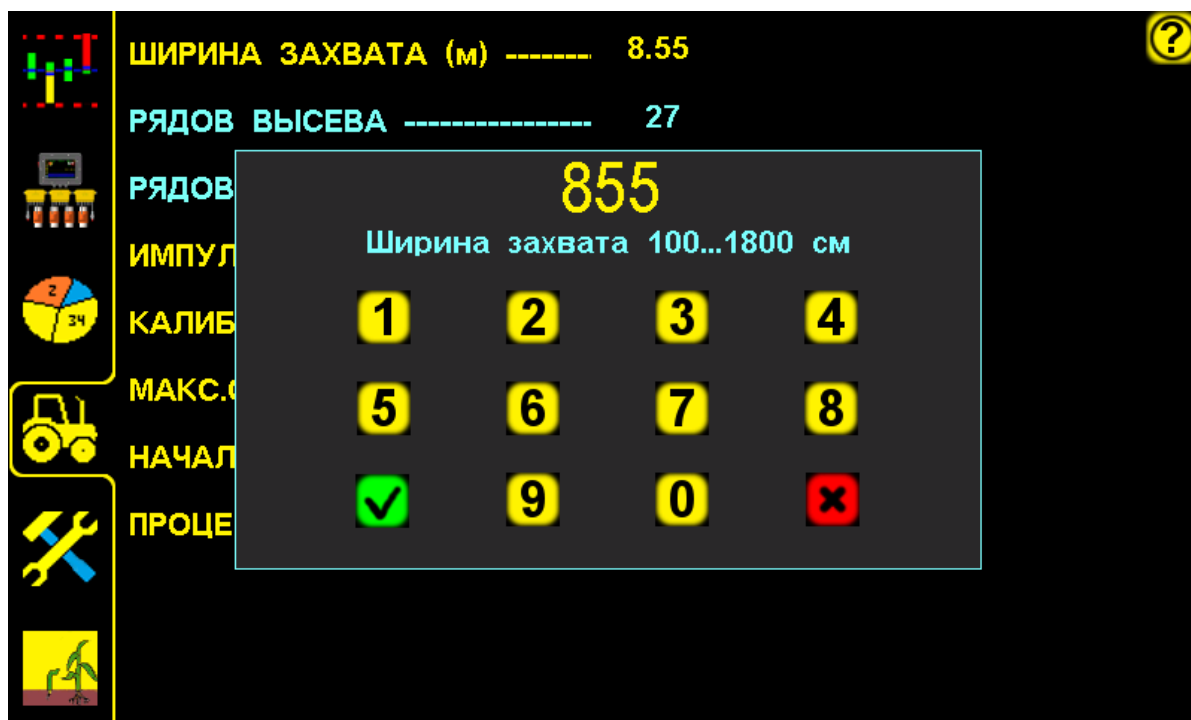
Установка рабочей ширины захвата сеялки рис.20
