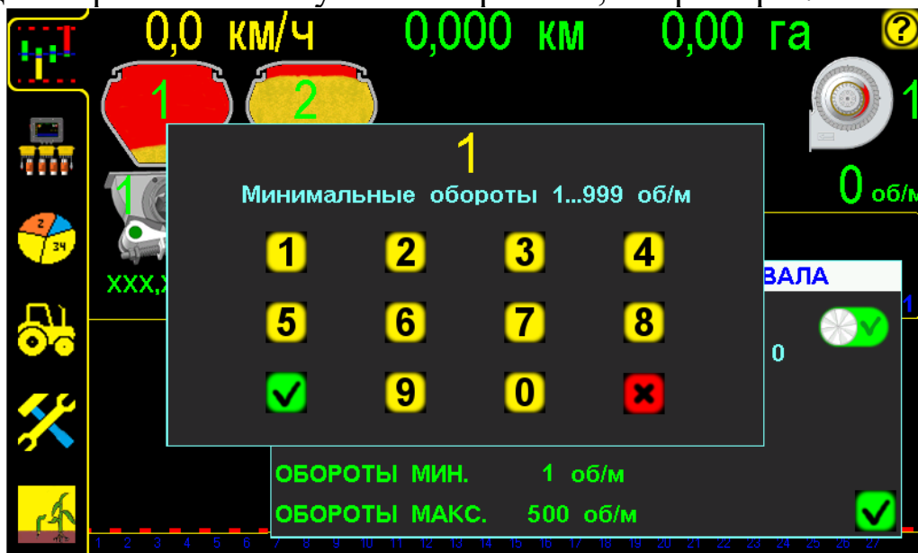
Установка минимального значения оборотов вала дозатора рис.13
