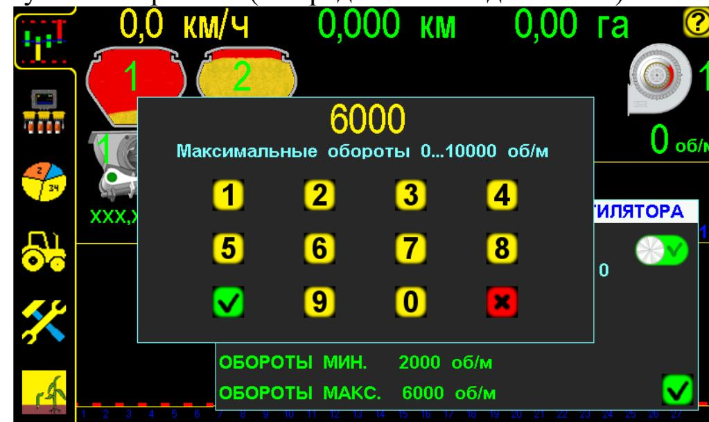
Установка максимального значения оборотов вентилятора рис.14
