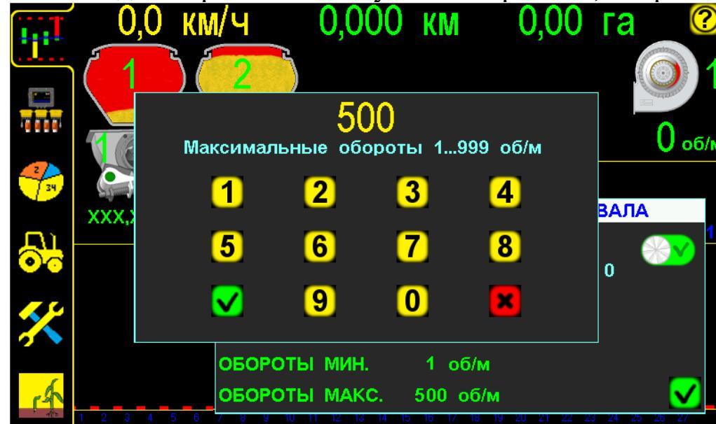
**Установка максимального значения оборотов вала дозатора рис.9**
