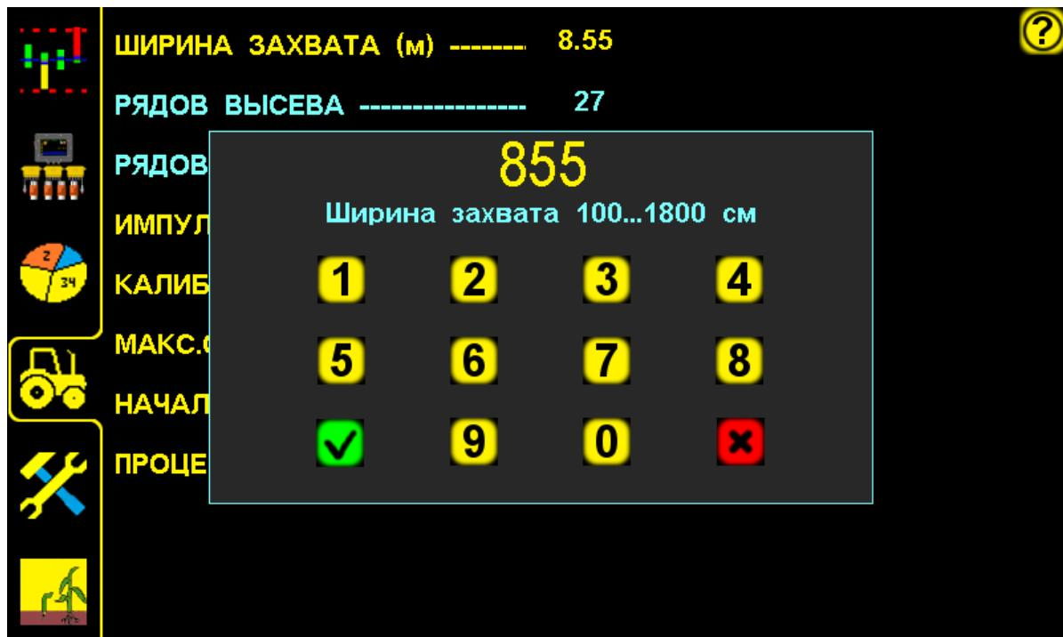
Установка рабочей ширины захвата сеялки рис.20
