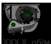
– отсутствие связи с Hub-ом – выдается «аварийное сообщение» «обрыв связи с хабом», с указанием номера Hub-a. Все датчики подключенные к этому Hub-у не активные [см. раздел 6 стр.53 рис.30] (номер «датчика оборотов вала дозатора» №1 и значение оборотов серого цвета).
