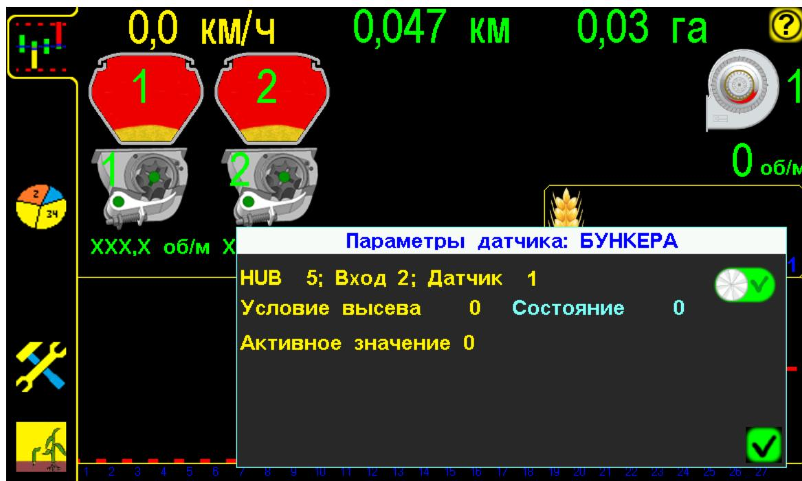
«Графический экран высева» с «окном показателей датчика бункера» рис.36
