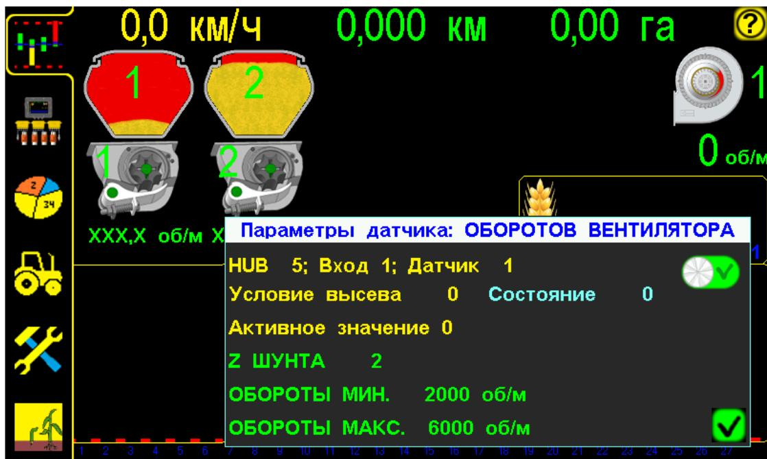
«Графический экран высеива» с «окном настроек» параметров «датчика оборотов вентилятора» рис.10
