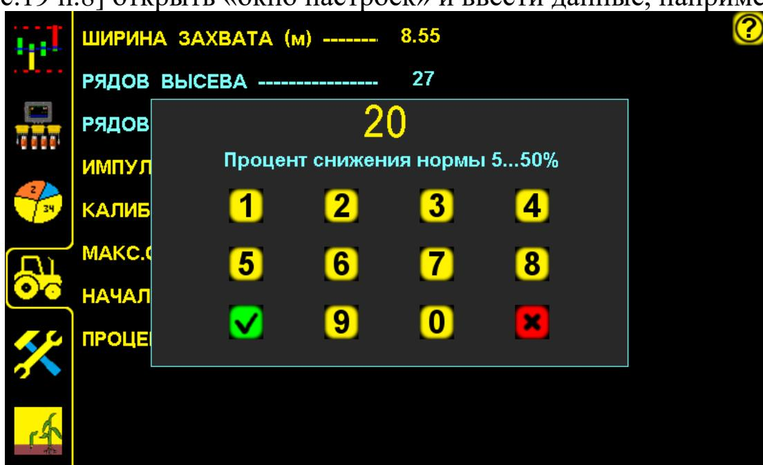
**Установка значения допустимого отклонения уровня «потока высева» рис.28**
