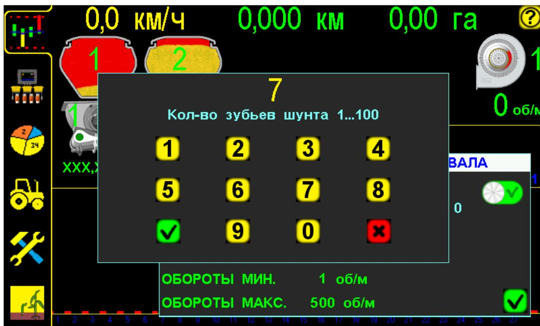
Установка количества зубьев шунта «датчика оборотов вала дозатора» рис.7
