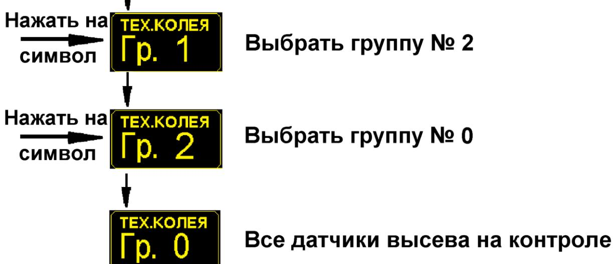
**6** и – «символы пролистывания» [см. стр.57 рис.35] - выбор номера «датчика высева» (если при нажатии высветился номер соседнего, выберите нужный номер, используя «символы пролистывания»)
