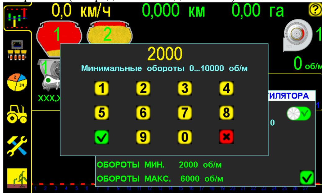
Установка минимального значения оборотов вентилятора рис.13
