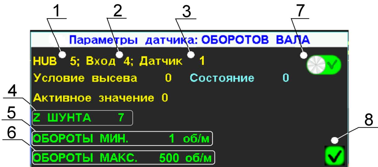
Фрагмент «графического экрана высеива» с «окном настроек» параметров «датчика оборотов вала дозатора» рис.6
