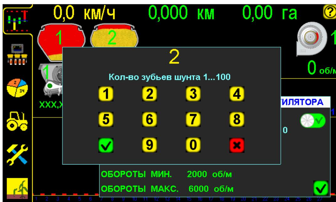
Установка количества зубьев шунта «датчика оборотов вентилятора» рис.12
