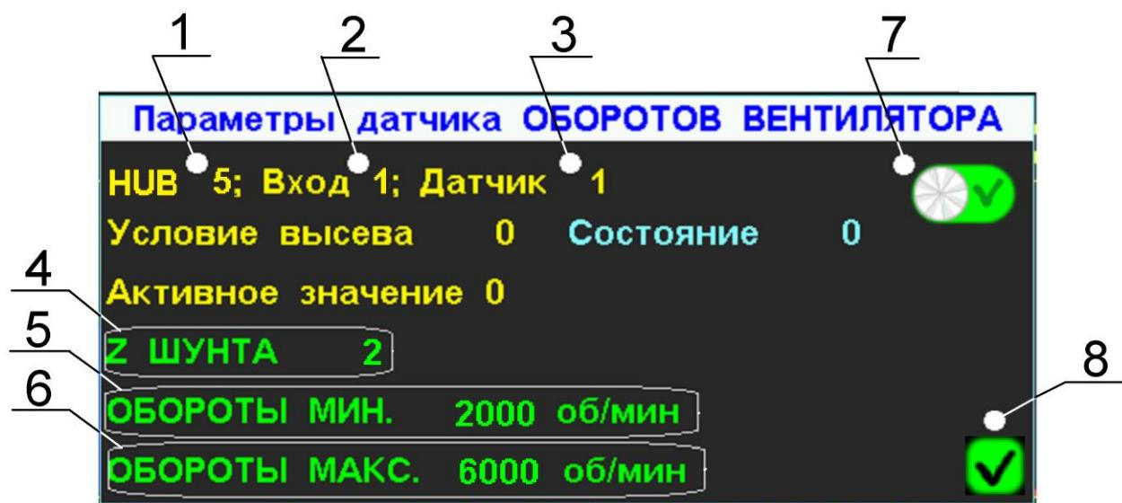
Фрагмент «графического экрана высеива» с «окном настроек» параметров «датчика оборотов вентилятора» рис.11
