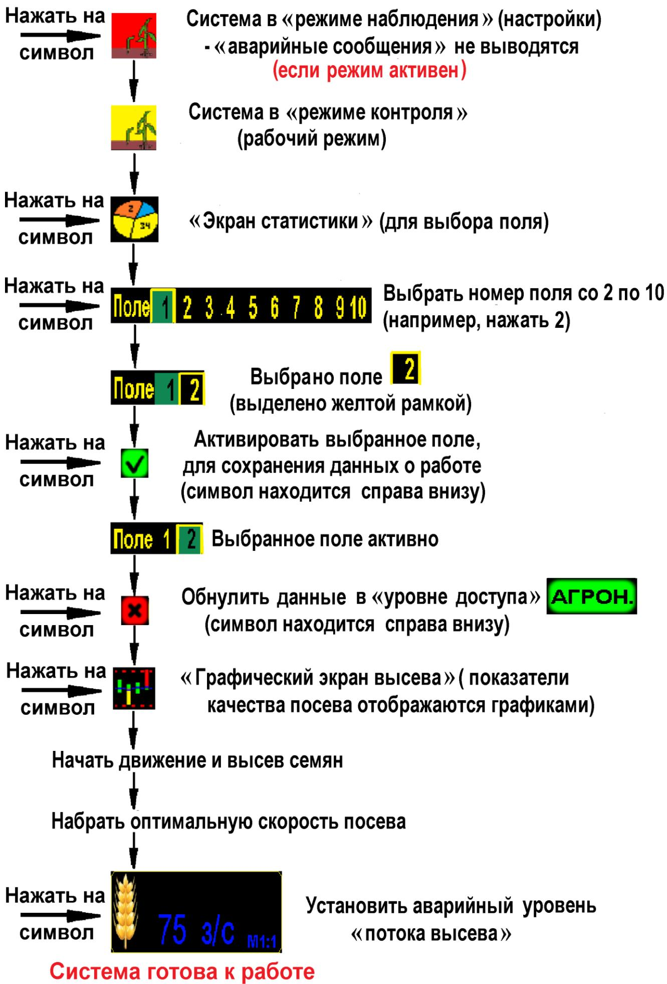
В процессе высева, на экране системы качество показателей работы сеялки отображается графиками, а цифровые значения показателей будут сохраняться в памяти панели высева.
