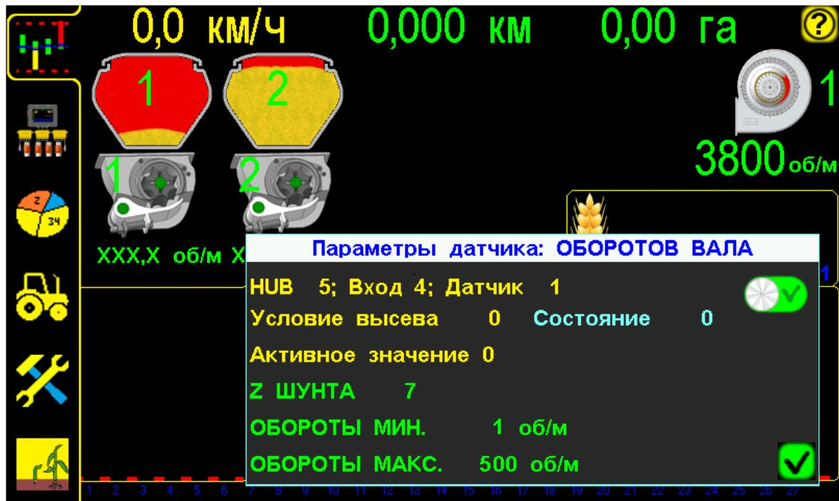
«Графический экран высеива» с «окном настроек» параметров «датчика оборотов вала дозатора» рис.5
