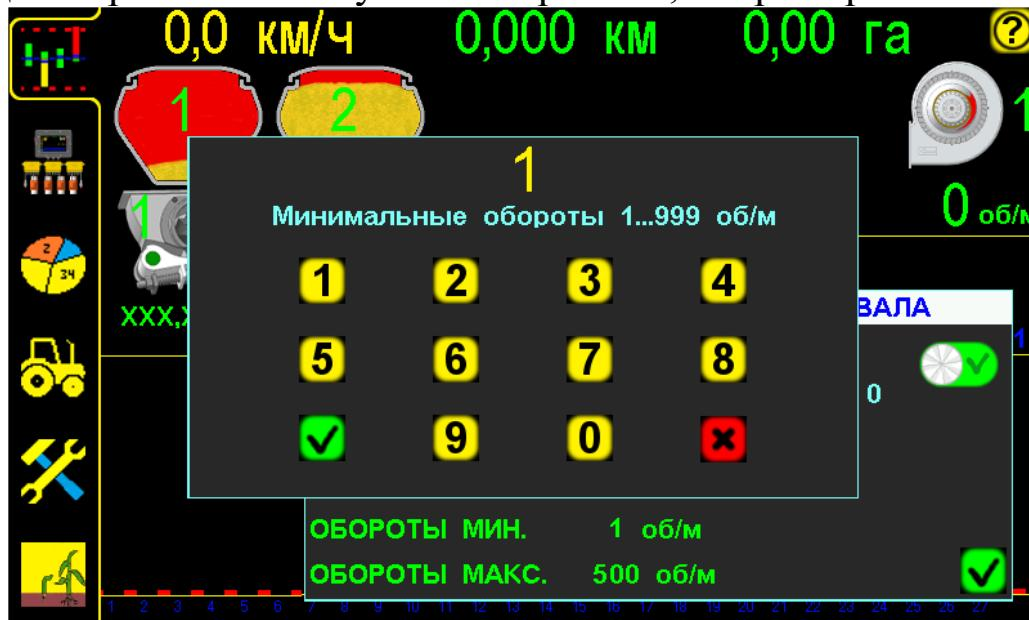
**Установка минимального значения оборотов вала дозатора рис.8**
