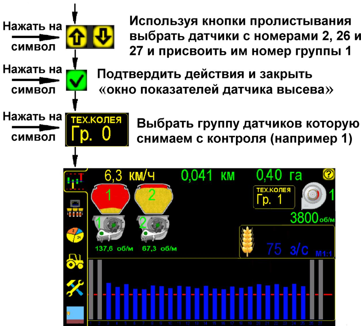
Датчики высева 1, 2, 26 и 27 относятся к группе №1 и сняты с контроля (при использовании сеялки с 23 рядами и шириной захвата 7,3м)
