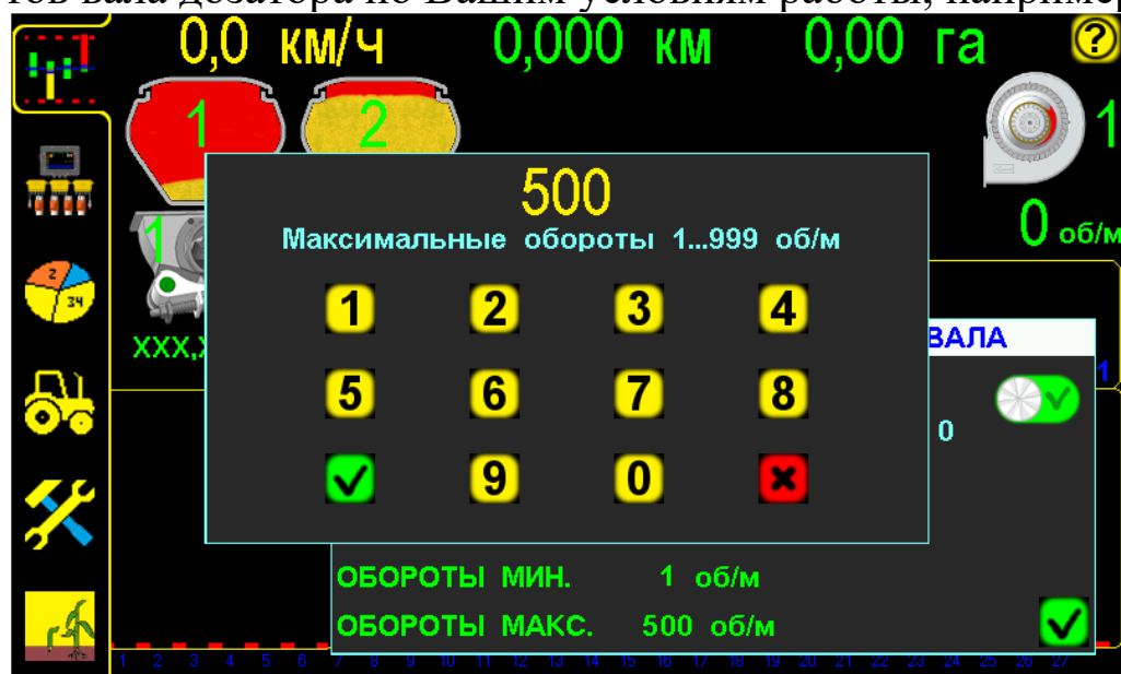
Установка максимального значения оборотов вала дозатора рис.14
