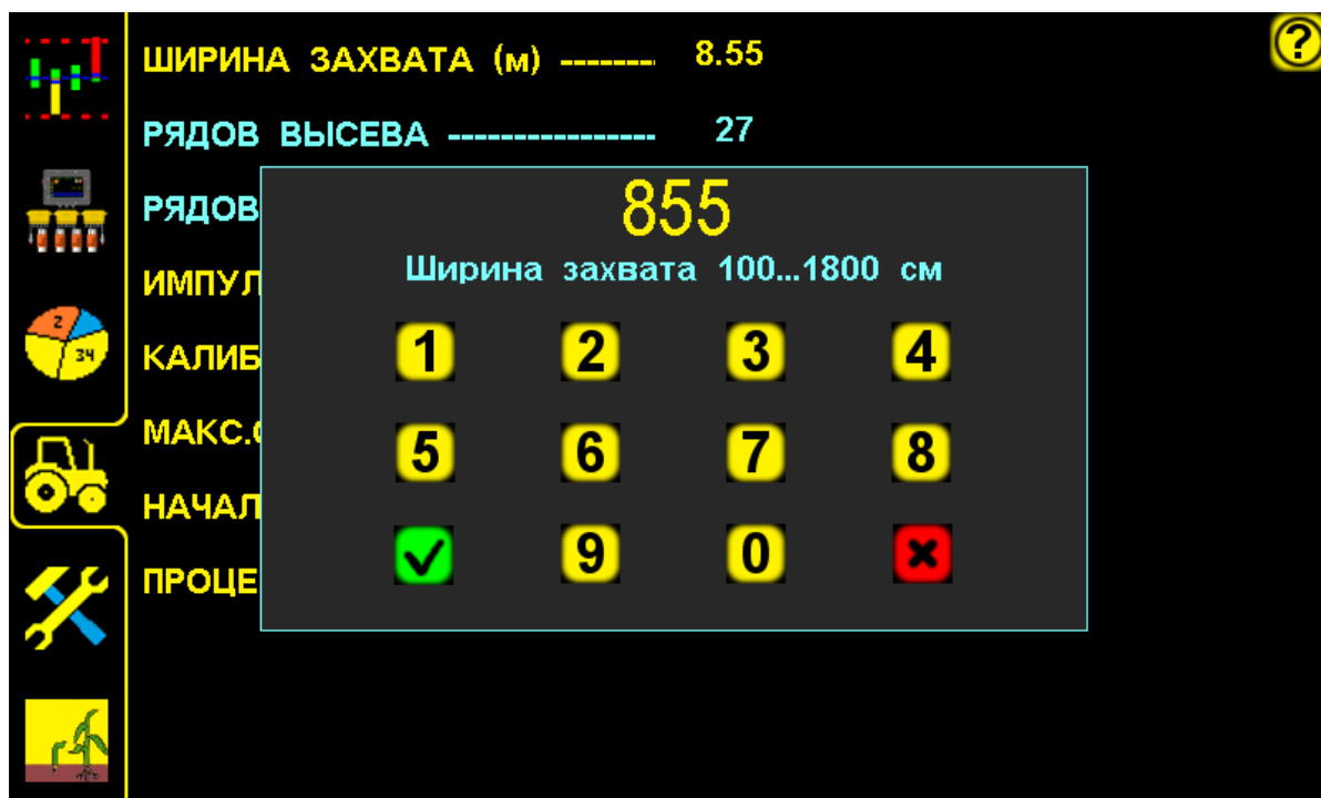
Установка рабочей ширины захвата сеялки рис.20
