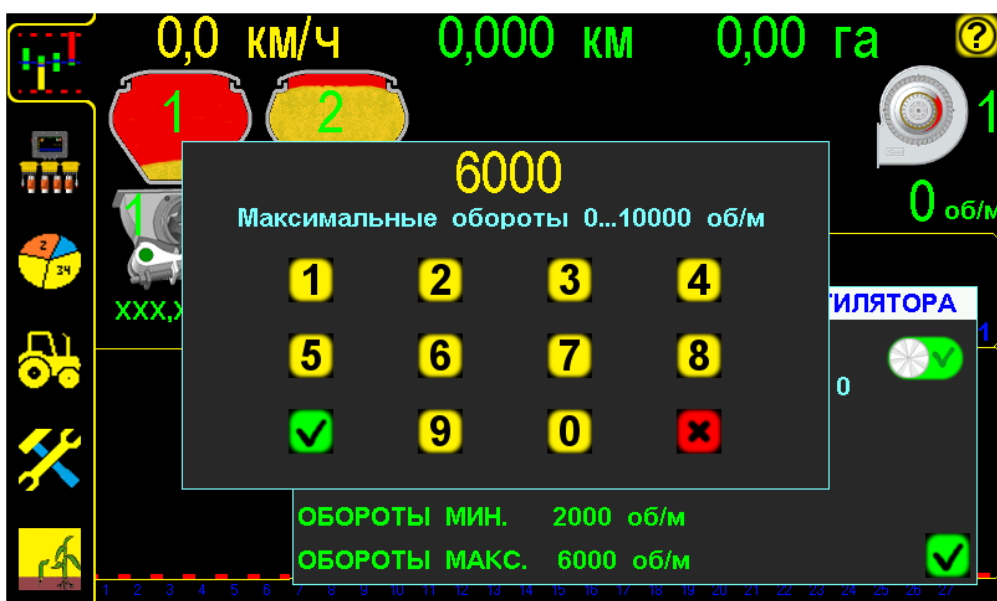
Установка максимального значения оборотов вентилятора рис.9
