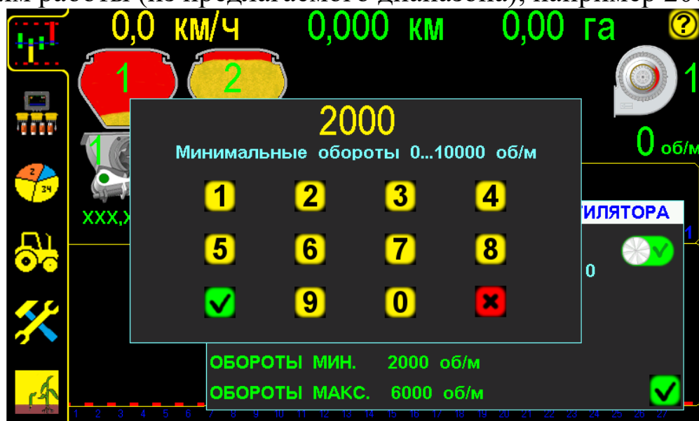
Установка минимального значения оборотов вентилятора рис.8
