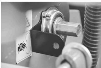
12. Устанавливаем на вал кронштейн крепления датчика пути и одеваем корпус подшипника на место.
