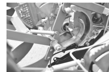
4. Конструкция датчика высева не препятствует пролету и исключает возможность попадания зерна мимо считывающих элементов.
