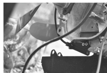
3. На место сбрасывателя теми же винтами устанавливаем датчик высева.
