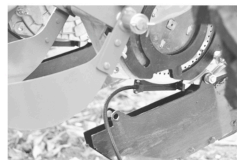
5. Собираем высевающий аппарат сеялки, ставим сошник на место.
