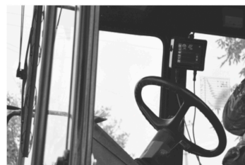
15. Панель высева с помощью универсального кронштейна закрепляем в кабине в наиболее удобном месте для контроля механизатором.
