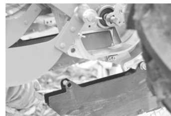
1. Разбираем крышку высевающего аппарата, снимаем сошник.
