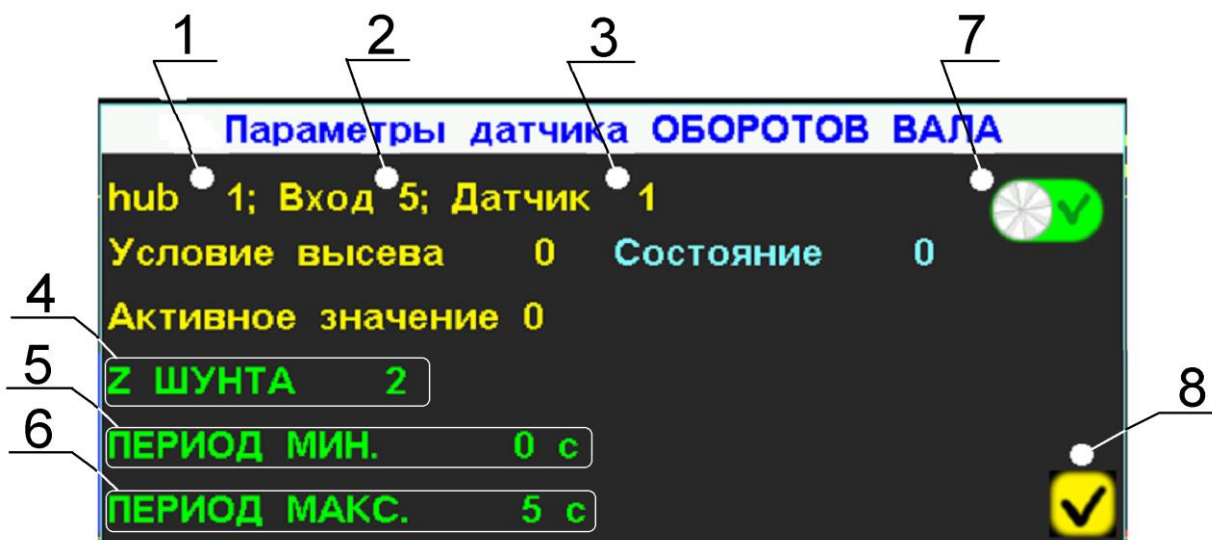
Фрагмент «графического экрана высева» с «окном настроек» параметров вала дозатора Рис.11
