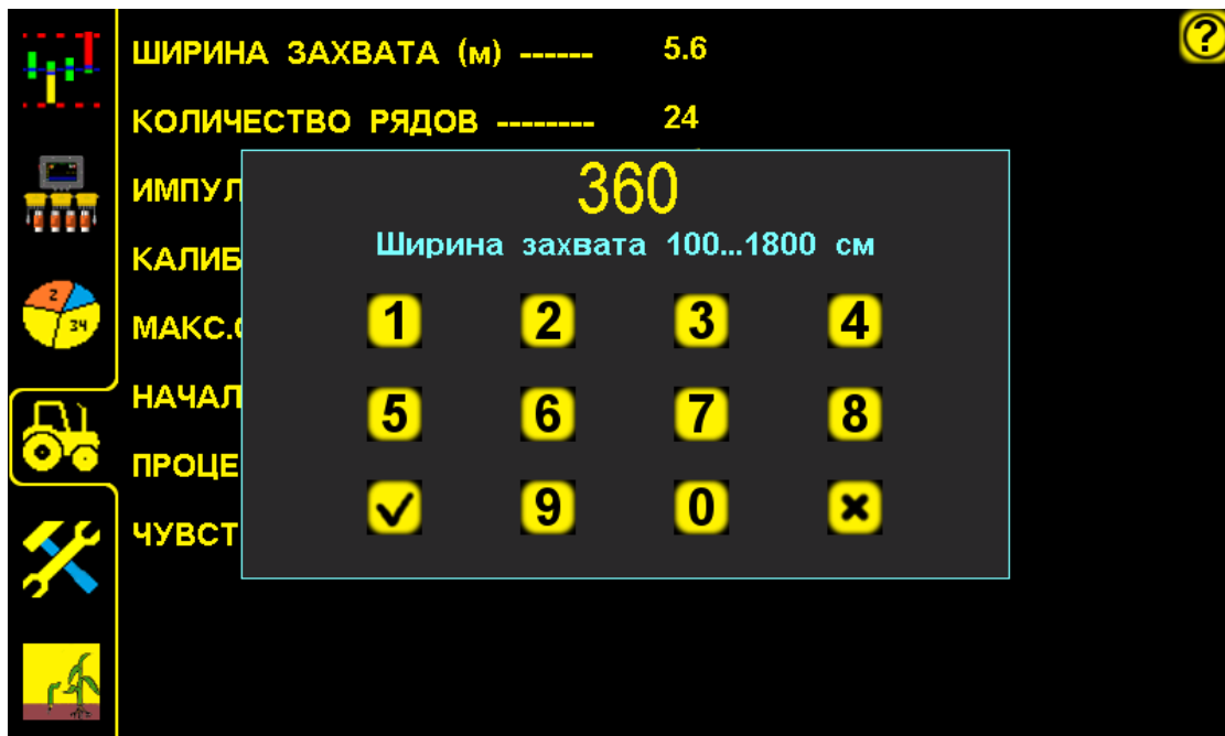
«Окно настроек» для ввода ширины захвата сеялки рис.19
