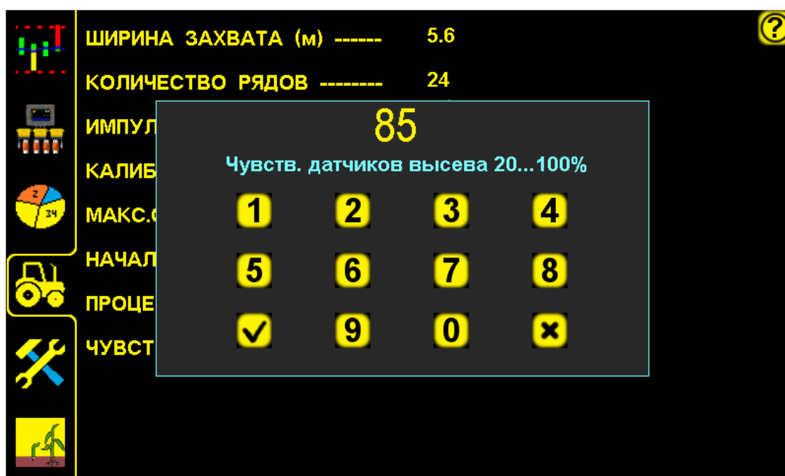
«Окно настроек» чувствительности датчиков высева Рис.27
