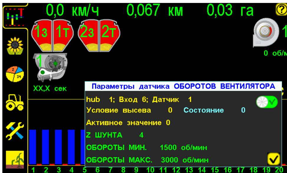
«Окно настроек» параметров датчика вентилятора Рис.5
